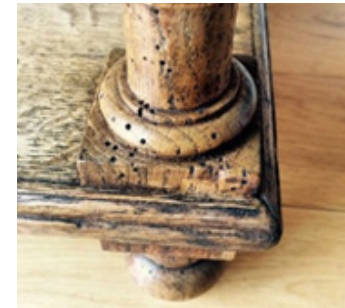
Foto 26 Punto di sfarfallamento legno
